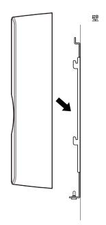
製品固定ねじを回して、BioEntry R2 をブラケットに組み付けます。
