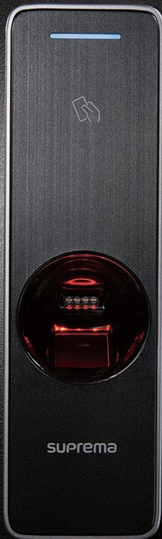
BioEntry W2는 슈프리마의 최신 지문인식 기술과 하드웨어 플랫폼을 기반으로 한 옥외형 지문인식 출입통제 단말기입니다. 동급 최고의 1.2GHz 쿼드코어 CPU를 탑재, 초고속 인증 성능과 신속한 장비 구동을 구현했으며 슈프리마의 차세대 지문인식 알고리즘과 위조지문 감지 기술(Live Finger Detection)을 적용, 보다 향상된 보안성능을 제공합니다. 또한, Dual-frequency RFID기술을 적용, 다양한 카드를 읽을 수 있으며 IP67인증의 방수방진 기능과 IK09의 반달프루프 구조를 제공하여 옥외 설치환경에 적합한 제품입니다.
