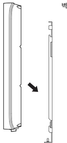
5 BioStation 3의 제품 고정용 나사를 돌려 BioStation 3와 브래킷을 조립하십시오.
