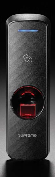
BioEntry P2는 슈프리마의 최신 지문인식 기술과 2세대 하드웨어 플랫폼에 기반 한 멀리언(Mullion) 타입 지문인식 출입통제 단말기입니다. 동급 최고의 1.0GHzCPU를 탑재, 초고속 지문인증과 신속한 장비 구동을 구현했으며, 차세대 지문인식 알고리즘과 최신 광학센서를 적용, 정확한 인증성능을 제공합니다. 또한 Dual-frequency(125kHz/13.56MHz) RFID기술을 적용, EM, MIFARE를 포함한 다양한 표준의 카드와 NFC통신을 지원하여 신축사이트, 레거시시스템 및 모바일 크리덴셜에 대한 완벽한 호환성을 제공합니다.
